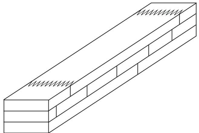
*Möglicher Aufbau einer NO LIMITS Kantel*
