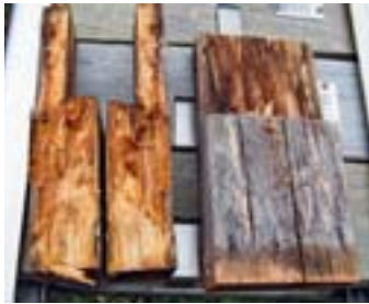
Gegenüber unmodifiziertem Holz, das beim Lap-Joint-Test auf Hawaii gänzlich zerstört wurde, ...
