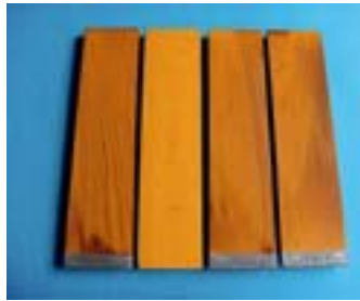
Auch beim QUV-Schnellbewitterungstest hell lasierter Prüflinge zeigt die unmodifizierte Kiefer (linkes Foto) ...
